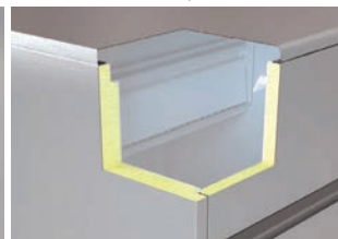
Relleno de la estructura de acero con espuma térmica
