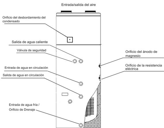
Conexión salida agua caliente: 3/4" macho
