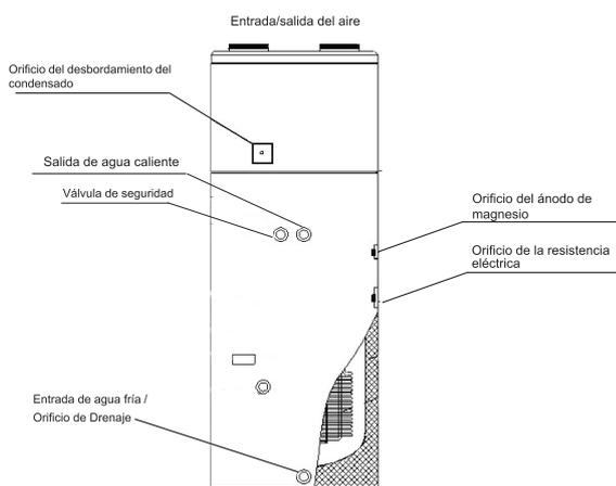
Conexión salida agua caliente: 3/4" macho
